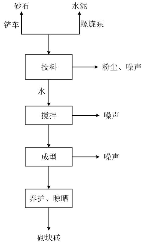
2-2 生产工艺流程及产污环节示意图
