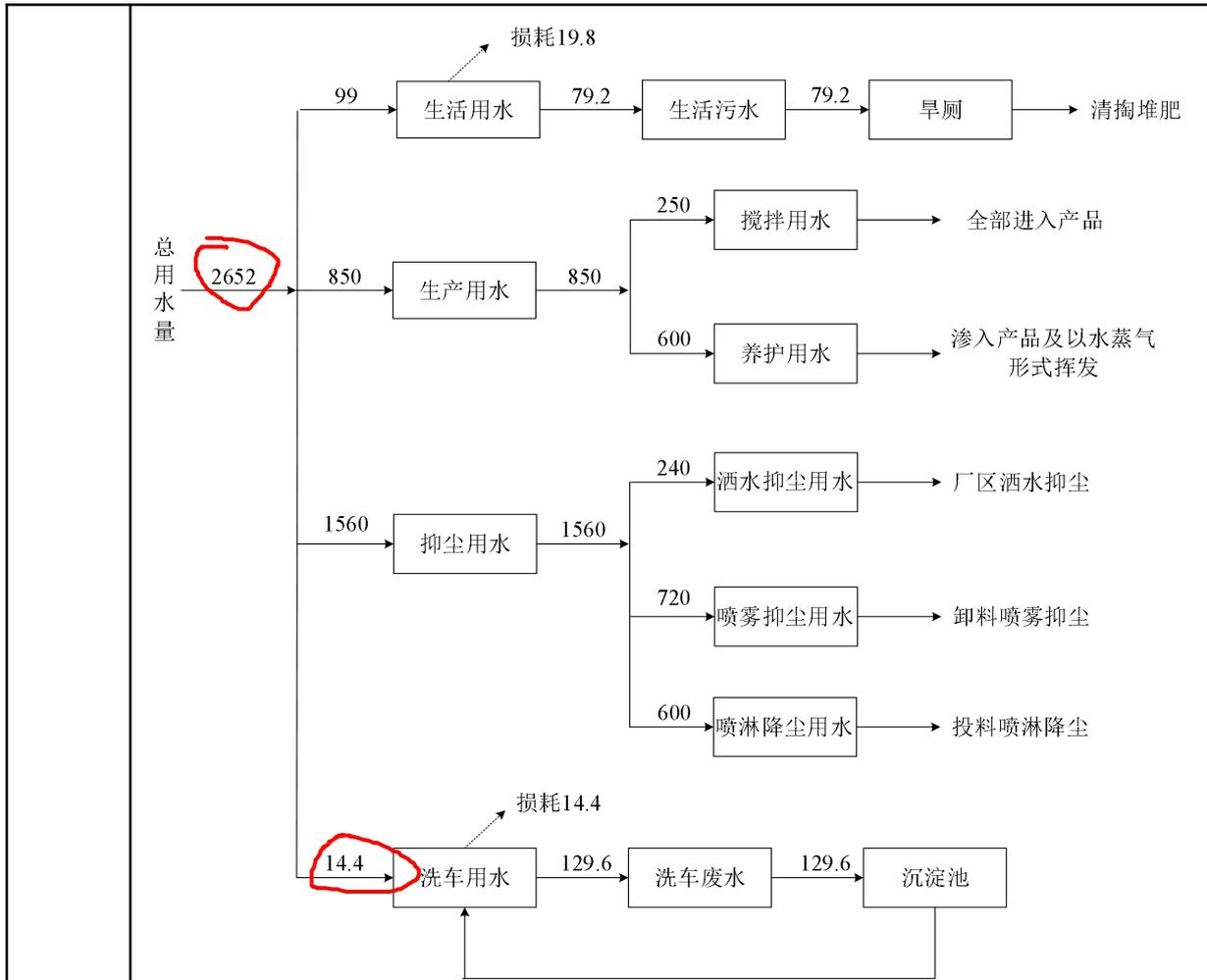
图 2-1 项目水平衡图 (单位: m³/a)
